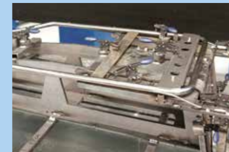
Design av robot sveisejigger i samarbeid med Shape AS.
